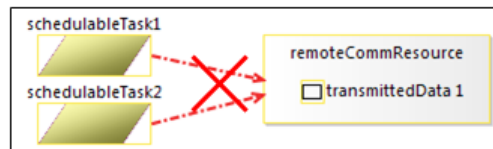
FIGURE 5.11 – Invariant pour éviter les doubles connexions
